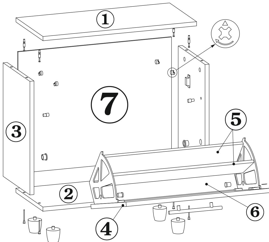
1. В отверстия на боковинах (дет.№3) вставьте втулки кронштейнов, ограничители и эксцентрики. Обратите внимание: стрелка на эксцентрике должна быть направлена к верхнему торцу детали. Шурупами 3x20 закрепите на правой боковине магнитную защелку.
