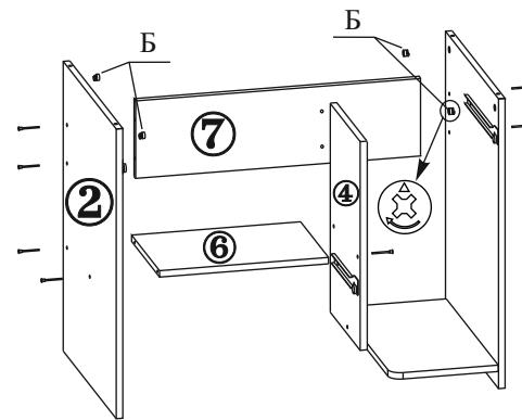
1.3. Соединить полученную тумбу и левую боковую стенку №2 с помощью полки №6, царги №7.
