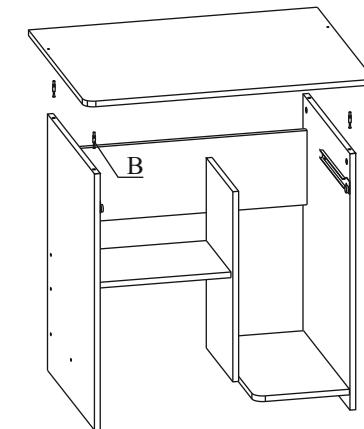
1.4. В отверстия с нижней стороны столешницы №1 заверните штоки эксцентриков (В). Опустите столешницу на боковины (дет.№2,3) таким образом, чтобы штоки эксцентриков вошли в отверстия на торцах боковин и поверните эксцентрики на боковинах на 180 градусов по часовой стрелке.
