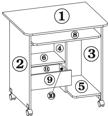
1.1. Закрепить на боковые торцы выкатной полки №8 ответные планки направляющих длиной 350мм (Д-2) с помощью шурупов 3,5x13 роликами назад.
